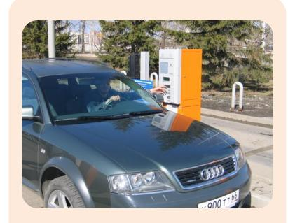
Стойка въезда является головным устройством модуля въезда. Предназначена для организации интерактивного диалога системы и клиента. Въездная стойка производит выдачу карт разовым клиентам, а так же позволяет осуществить въезд автомобилей по картам постоянных клиентов.
